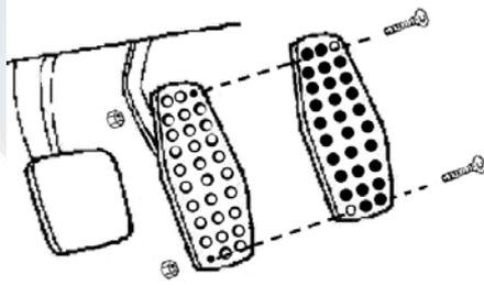
Die Kupplungs- und Bremspedalabdeckung montieren Sie wie folgt. Schieben Sie die Abdeckung von unten über die Pedalplatte. mit einem kleinen Schraubendreher hebeln Sie den Gummi über die Pedalplatte.
