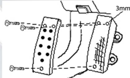
Die Gaspedalplatte wird auf das Gaspedal gelegt und mit den im Lieferumfang enthaltenen Schrauben (M5 x 20mm) befestigt
